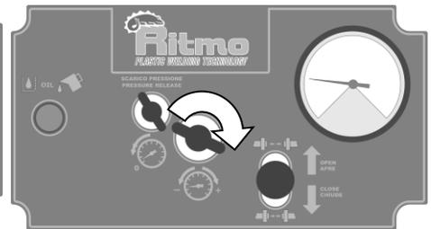
Per rilevare la pressione di trascinamento  $P_t$ , tirare completamente la leva della centralina e ruotare in senso orario la valvola di massima pressione per aumentare gradualmente la pressione fino a quando il carrello mobile comincia a muoversi. Leggere sul manometro il valore di pressione di trascinamento  $P_t$  e annotarlo.
